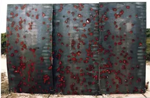
Дејство пројектила 76 mm на макећу ракете (лево) и приказ фрагментационог дејства
